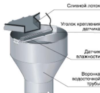
Датчик для Кровли состоит из двух частей – собственно сам датчик влажности и температуры и кабель длиной 15 м для подключения регулятору Devireg 850.
